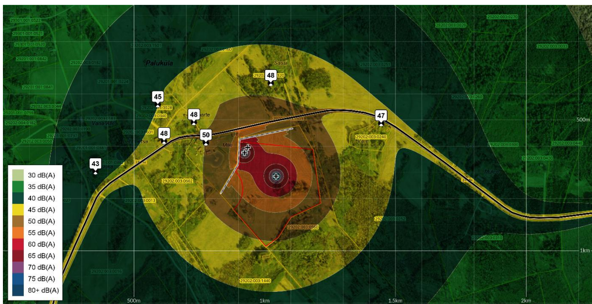
Joonis 6.3 Mõra hajumise mudel kaevandamisel (ilma PSS-ta), kus mustad ristid tähistavad mürallikaid (ekskavaator, frontaalladur ja kallurauto) ja musta-valgega joon mäeeraldise teenindusmaa perimeetrit tähistab rajatavat müratõkkevalli. Lisaks on kaevise väljavedu silmas pidades arvestatud mõnevõrra kõrgema liiklusemüraga.
